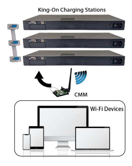
每一個金恩科技的標準充電系統出廠時,ID 的預設值均為1,然而**當 CMM 同時連結多台時,每一台標準充電系統的 ID 不得相同,否則將導致系統衝突而無法動作**,因此需要進行 ID 設定:
